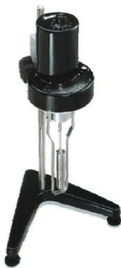
Slika 4. Spoljni izgled Viskozimetra po Brukfeldu
