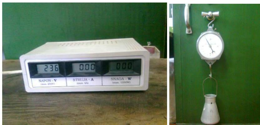
Slika 5. Spoljašnji izgled digitalnog uređaja za merenje snage
